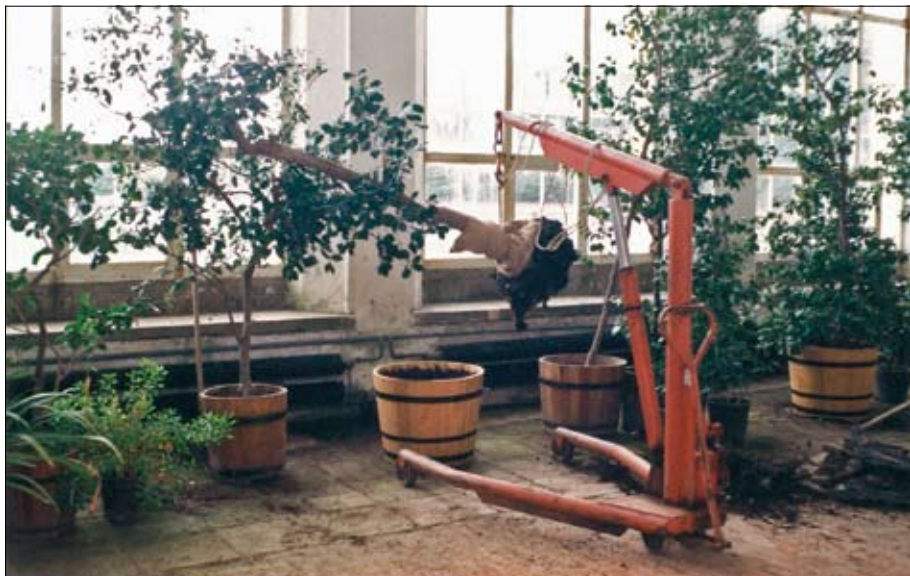
Obr. 23: Rameno používané v Koštné zahradě v Kroměříži pro vyvednutí velkých rostlin při přesazování. (Foto L. Vašák, 2001).
