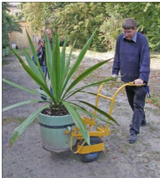
Obr. 10: Dvougolový ruční vozík speciálně upravený pro transport rostlin v nádobách – Sanssouci. (Foto L. Křesadlová, 2009)
