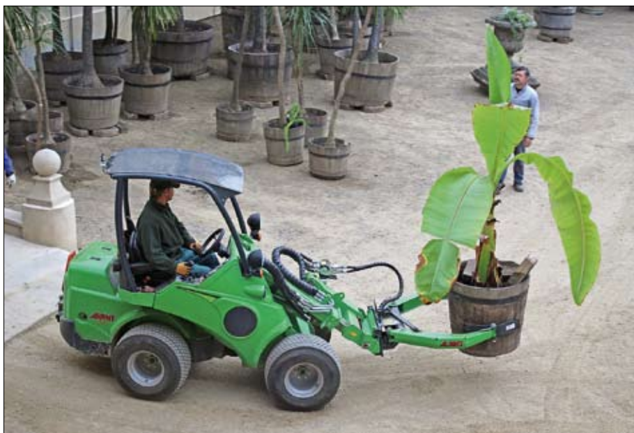
Obr. 16: Manipulace s rostlinami pomocí přídatného zařízení na multifunkčním nakladači v Kočetné zahradě v Kroměříži. (Foto P. Hudec, 2015)
