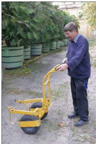
Obr. 10: Dvougolový ruční vozík speciálně upravený pro transport rostlin v nádobách – Sanssouci. (Foto L. Křesadlová, 2009)
